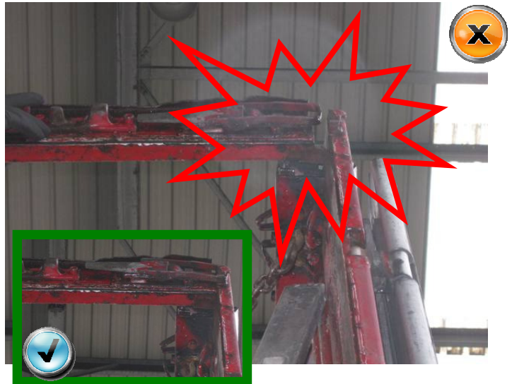
En lugar de enganchar la grapa que sujeta la barra horizontal en la que cierran las puertas de la Tauliner, la deja posada sobre un saliente, mientras el continúa con el cierre del camión.
