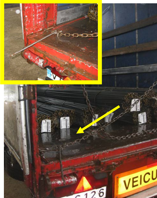
El transportista, desde el suelo tensa las cadenas que sujetan las paredes laterales del camión.
